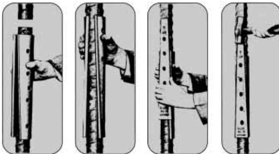
G-Loc®-Klemmen für Betonstahl nach DIN 488
